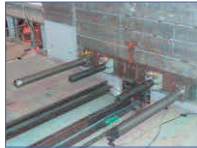
Oben: Aufprallrohre / Bremsen Oben: freistehende Testgewichte Links: Anlaufunnel
